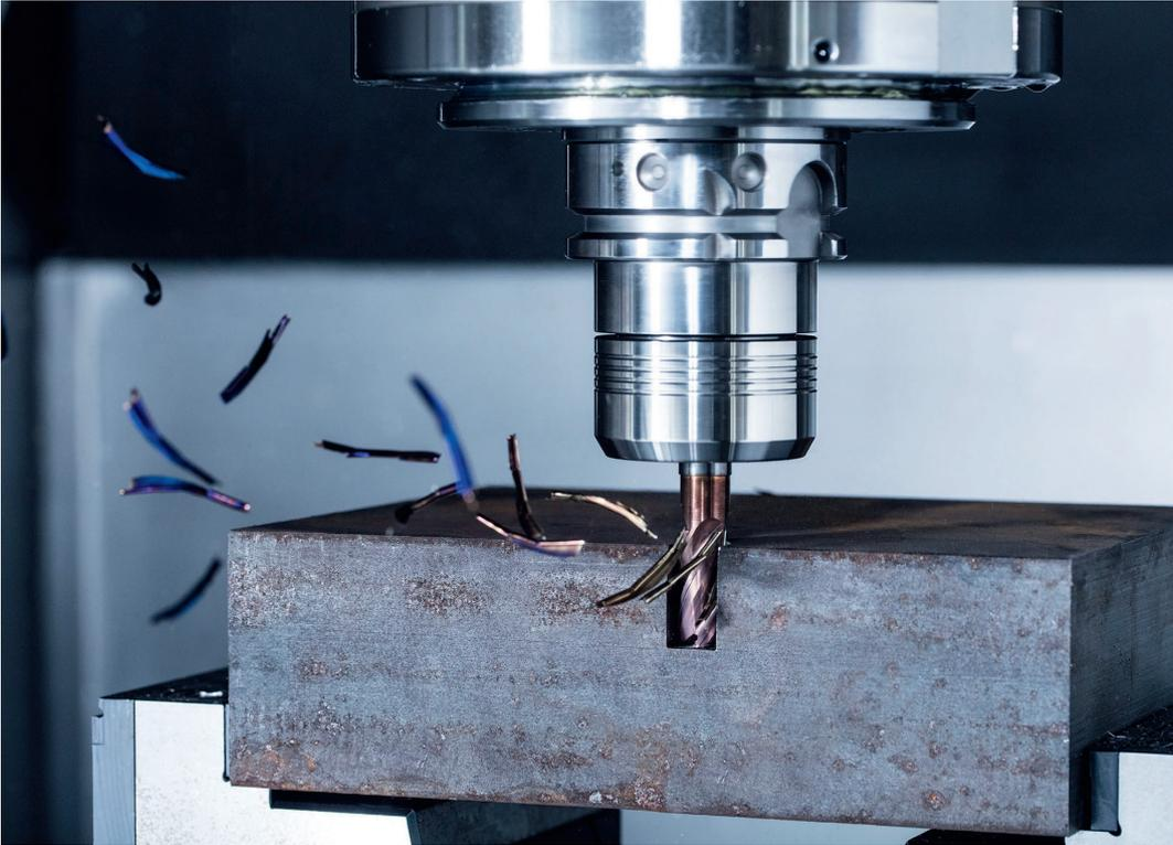
1 Mit Fräsern von Ceratizit erfüllt der Lohnfertiger Herzog alle Anforderungen aus dem Anlagenbau für die Pharma-Industrie. Hier ein S-Cut, der für das Spanen von Stahl und rostfreiem Werkstoff prädestiniert ist © Ceratizit
